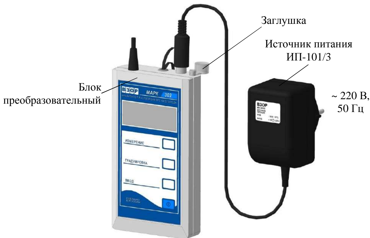
Рисунок 3.2 – Зарядка аккумуляторных батарей
